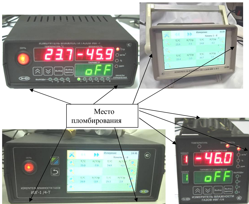
Рисунок 15 - Схема пломбирования измерителей от несанкционированного доступа (стрелками указаны места пломбирования от несанкционированного доступа)
