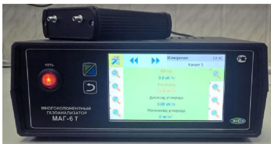
Рисунок 6 – Внешний вид газоанализатора МАГ-6 исполнения МАГ-6 Т-8 (с одним внешним измерительным преобразователем МАГ-6)
