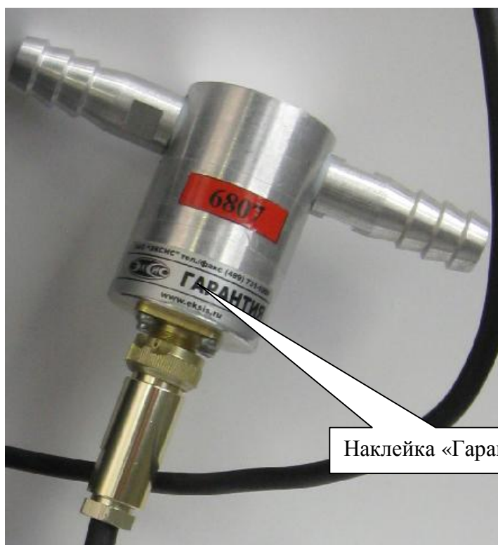
Рисунок 5 – Схема пломбировки выносного измерительного преобразователя
