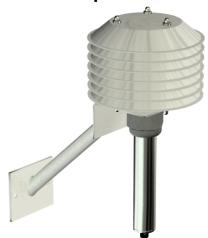
Защитный экран УЗКВ предназначен для использования с термогигрометрами серии ИВТМ-7 при проведении измерений на открытом воздухе. Экран разработан для защиты выносных преобразователей от атмосферных осадков (дождя, снега), а также от солнечных лучей (перегрева датчика), что достигается благодаря специальному покрытию и конструктивному исполнению экрана.
