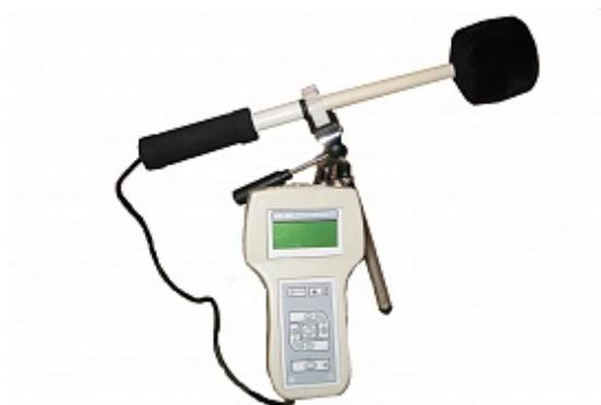
Измеритель электромагнитного поля промышленной частоты
