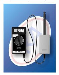
Измеритель относительной влажности и температуры воздуха внутри помещений ТКА-ПКМ-20.
