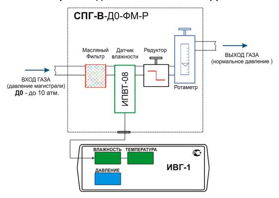
Системы СПГ-В осуществляют фильтрацию газа, измерение давления газа и контроль за расходом газа в зависимости от исполнения
