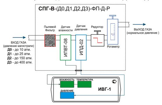
Системы СПГ-В осуществляют фильтрацию газа, измерение давления газа и контроль за расходом газа в зависимости от исполнения
