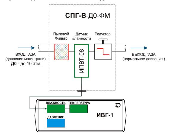
Системы СПГ-В осуществляют фильтрацию газа, измерение давления газа и контроль за расходом газа в зависимости от исполнения
