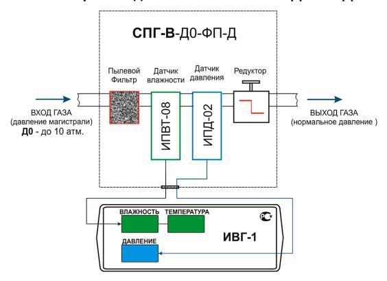
Системы СПГ-В осуществляют фильтрацию газа, измерение давления газа и контроль за расходом газа в зависимости от исполнения
