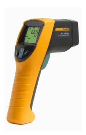
Характеристика пирометра Fluke 561 Инфракрасные измерения с лазерным наведением Инфракрасный режим позволяет проводить измерения температуры в пределах двух метров от объекта и отслеживать состояние воздуховода, не вставая на лестницу. Система лазерного целеуказания для определения точки считывания Одноточечный лазер приблизительно указывает центр измеряемой области. Измеряемая область увеличивается с увеличением расстояния.
