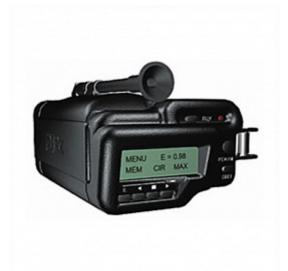
Пирометр микропроцессорный С-500.2 Самоцвет предназначен для бесконтактного измерения температуры поверхностей твердых (сыпучих) тел, воды по их собственному тепловому излучению.
