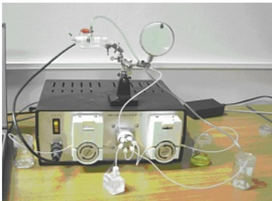
Проточно-инжекционный анализатор для электрохимических экспресс-измерений
