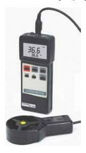
Анемометр АТТ-1003 представляет собой крыльчатый анемометр с возможностью одновременного измерения скорости и температуры воздушного потока.
