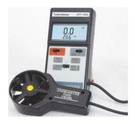
Анемометр АТТ-1002 представляет собой крыльчатый анемометр с возможностью одновременного измерения скорости и температуры воздушного потока.
